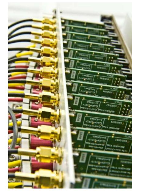
Toda la línea de luz está controlada por **ordenador**. Se controlan más de 100 motores por línea. El sistema de vacío y protección tiene más de 200 canales y el sistema de **adquisición de datos** puede generar hasta 1 Terabyte al día.
