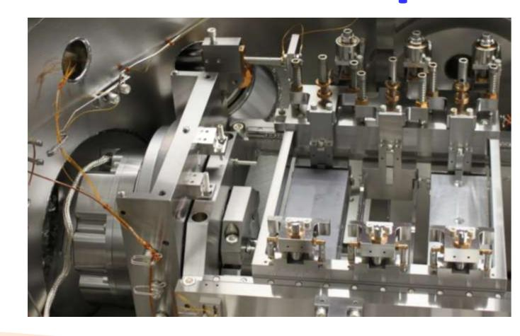
Los sistemas mecánicos son capaces de **posicionar un elemento óptico** con la precisión de una milésima de milímetro.
