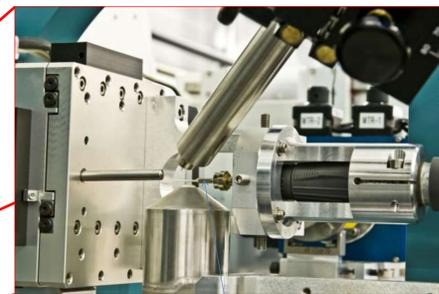
**Muestra en forma de polvo dentro de un capilar de vidrio** de diámetro ~0.5mm, montada en la estación experimental.
