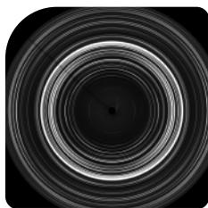
**Si los átomos no están tan bien ordenados**, la imagen que se obtiene en la pantalla tiene forma anular. A partir de los anillos, y gracias a técnicas matemáticas, se puede conocer la estructura interna de la muestra en 3D. **Este proceso se llama *difracción de polvo***.
