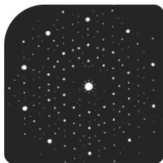
**Si los átomos están ordenados** y forman estructuras que se repiten con regularidad en el espacio, se puede observar con mucha precisión de qué manera han desviado los rayos X. **Este tipo de difracción**, que permite deducir exactamente la estructura interna de la muestra en 3D, **se conoce como *monocristalina***.
